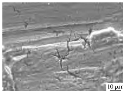
图6 表面裂纹微观形貌 SEM 照片
