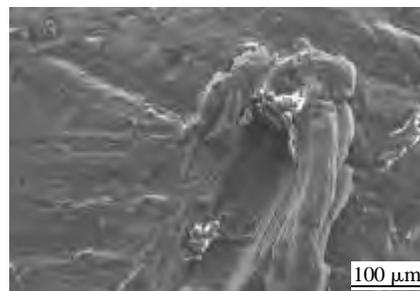
图 3 切削犁沟 SEM 照片
